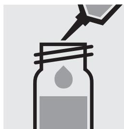
Pipetear 6,0 ml de la muestra en una cubeta de reacción, cerrar con la tapa roscada y mezclar.
