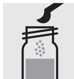
Añadir 1 microcuchara gris rasa de **Zn-5**, cerrar la cubeta con la tapa roscada y disolver la sustancia sólida.
