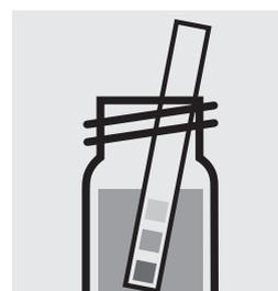
Comprobar el valor del pH, intervalo necesario: pH 4–10. En caso necesario, corregir el valor del pH añadiendo gota a gota solución diluida de hidróxido sódico o de ácido sulfúrico.
