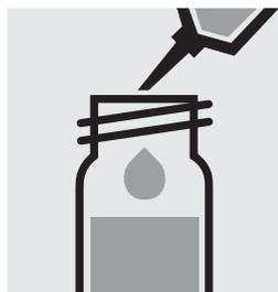
Pipetear 1,0 ml de la **muestra preparada** en un tubo de ensayo, **no mezclar**.
