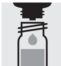
Mezclar el filtrado con 4 gotas de  $\text{SO}_4\text{-4}$  y cerrar con la tapa rosca.
