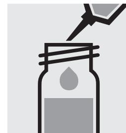
Añadir 5,0 ml de **OA-5** con la pipeta, cerrar la cubeta con la tapa roscada y agitar intensamente.
