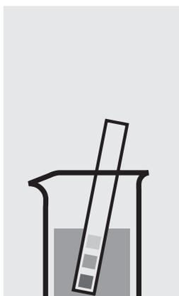
Comprobar el valor del pH de la muestra, intervalo necesario: pH 6–7. En caso necesario, corregir el valor del pH añadiendo gota a gota solución diluida de hidróxido sódico o de ácido nítrico.
