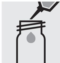
Pipetear 10 ml de la muestra en un tubo de ensayo (tubos de fondo plano, art. 114902).
