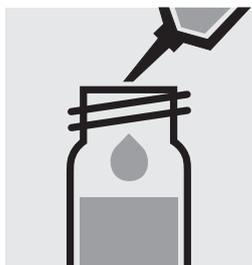
Añadir 2,0 ml de la muestra con la pipeta **cuidadosamente** en una cubeta de reacción, cerrar firmemente con tapa rosca y mezclar intensamente. **¡Atención, la cubeta se calienta!**
