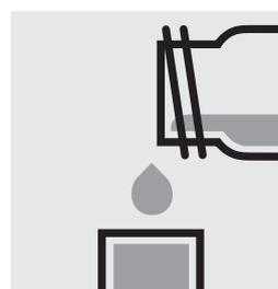
Introducir la muestra de medición en una cubeta rectangular y medir **inmediatamente**.
