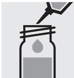
Pipetear 1,0 ml de la muestra en una cubeta de reacción, cerrar con la tapa rosca y mezclar.
