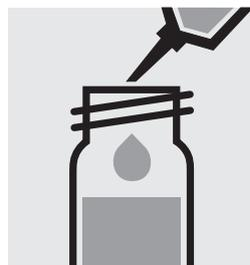
Añadir 5,0 ml de la muestra preparada con la pipeta, cerrar con la tapa roscada y mezclar.
