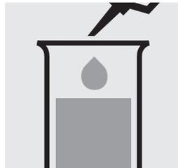
Pipetear 0,10 ml de la muestra en un tubo de ensayo.
