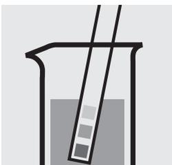
Comprobar el valor del pH de la muestra, intervalo necesario: pH 4–10. En caso necesario, corregir el valor del pH añadiendo gota a gota solución diluida de hidróxido sódico o de ácido clorhídrico.
