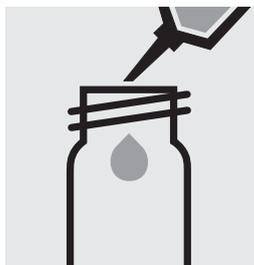
Pipetear 5,0 ml de la muestra en una cubeta de reacción, cerrar con la tapa roscada.
