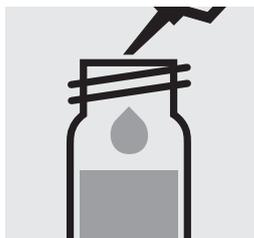
Pipetear 10 ml de la muestra en una cubeta de reacción, cerrar con la tapa roscada y mezclar.
