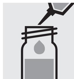
Añadir 1,5 ml de la **muestra preparada** con la pipeta muy lenta, cerrar con la tapa rosca-da y mezclar **brevemente**. **¡Atención, la cubeta se calienta!**
