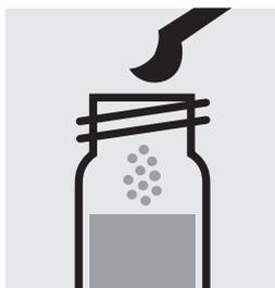
Verter 1 microcuchara amarilla rasa de  $\text{NO}_3\text{-1K}$  en una cubeta de reacción, cerrar con la tapa roscada.
