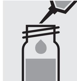
Añadir 5,0 ml de agua destilada (recomendamos el art. 116754, Agua para análisis EMSURE®) con la pipeta en una cubeta, cerrar con la tapa roscada y mezclar.
