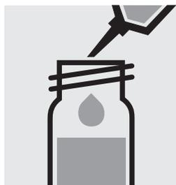
Añadir 1,0 ml de la muestra con la pipeta **cuidadosamente** en una cubeta de reacción, cerrar firmemente con tapa roscada y mezclar intensamente. **¡Atención, la cubeta se calienta!**
