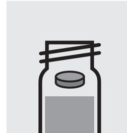
Añadir 1 **comprimido de reactivo Cyanuric Acid**, aplastar con la barra agitadora y cerrar con la tapa roscada.
