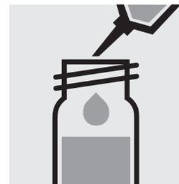
Añadir 7,0 ml de la muestra con la pipeta en una cubeta, cerrar con la tapa roscada y mezclar.
